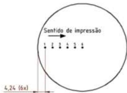
**Figura 1.** Seção transversal esquemática com pontos de onde foi medida a dureza das amostras
