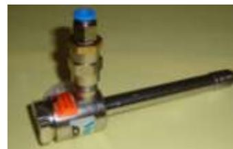
**Figura 6.** Tubo de vórtice utilizado no processo de resfriamento a ar comprimido
