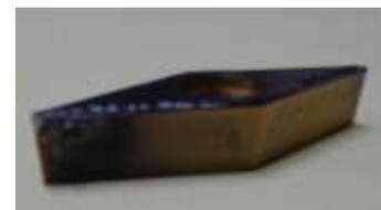
Figura 9. Inserto T04 após ciclo de ensaio através de refrigeração de corte a seco
