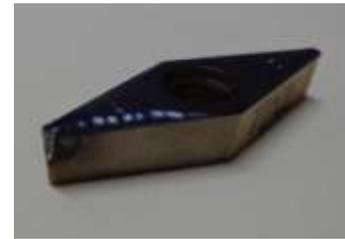
Figura 8. Inserto T01 após ciclo de ensaio através de refrigeração de corte por imersão
