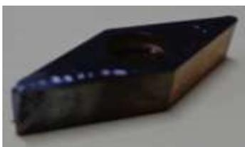
**Figura 11.** Inserto T07 após ciclo de ensaio através de refrigeração de corte a ar comprimido resfriado por tubo de vórtice
