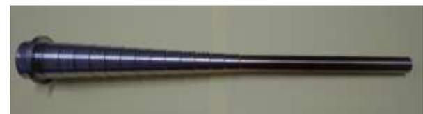
Figura 10. Corpo de prova usinado através do sistema de corte a seco
