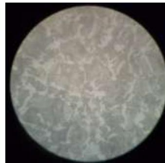
**Figura 2.** Micrografia de amostra do aço ABNT 1045. Ampliação de 1600x. Ataque: Nital 10%
