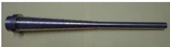
**Figura 12.** Corpo de prova usinado através do sistema de refrigeração de corte a ar comprimido resfriado por tubo de vórtice
